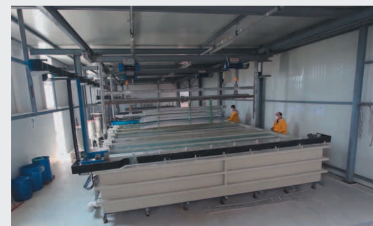
Процесс покрытия проводников оловом
