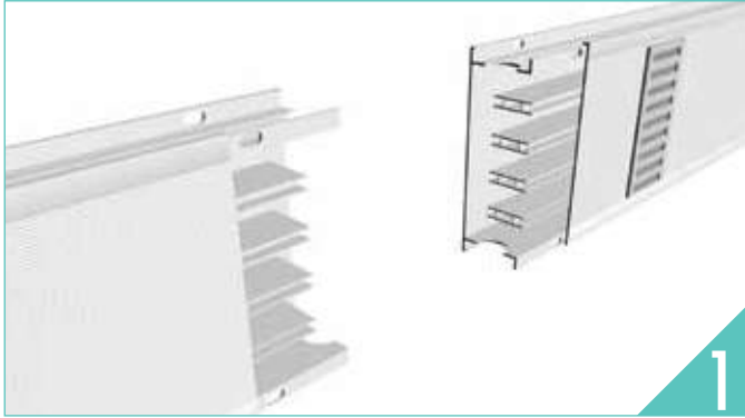
1) Ek eleman yan plastiklerini monte ediniz. 1) Assemble side covers of joint points. أغطية تجميع جانبية لنقاط الوصلات
