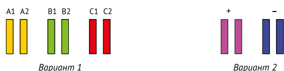
Рис. 4. Шинопроводы с расщепленными фазами.
