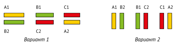
Рис. 5. Схемы шинопроводов со спаренными фазами.
